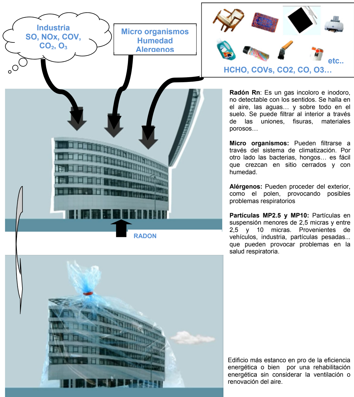
Figura 4b: Esquema, contaminantes en el aire interior
